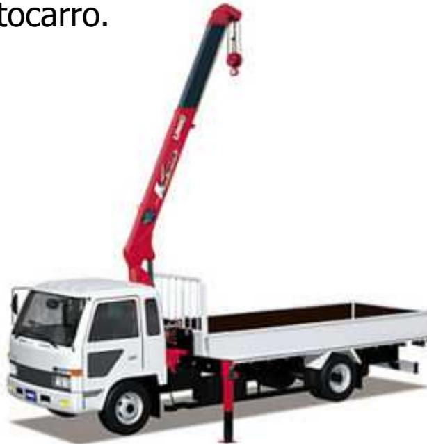
Le **autogru** sono gru mobili installate su carro proprio. L'autogru è un automezzo pesante in grado di provvedere alla movimentazione di materiali in località dove non è disponibile una installazione fissa. La versione più specifica corrisponde ad un veicolo gommato a guida singola con un grande e solido braccio allungabile facente funzione di gru. L'autogru **non è destinata a caricare il mezzo sul quale è posizionata**.
