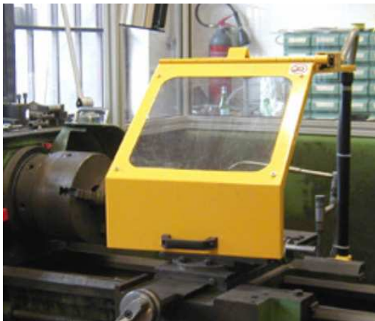
Riparo mobile interbloccato per carrelli di torni paralleli
