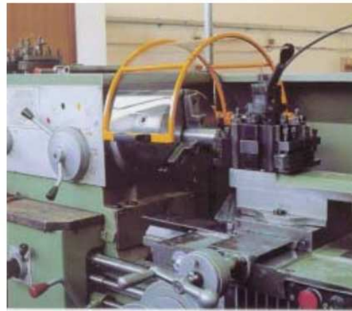
Riparo mobile interbloccato per mandrini di torni paralleli
